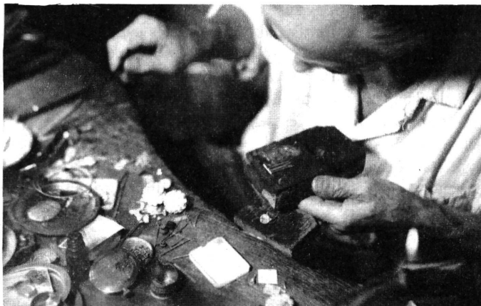
7. kép. Fésű alakba készítették forrasztáshoz a fülbevalók „rúdját”, a hozzájuk tartozó csuklópánttal. Horváth Terézia felvétele
